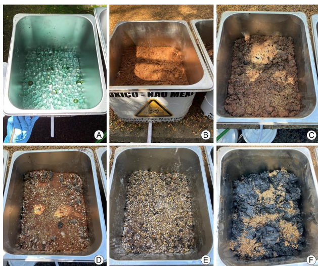
Figura 1. Montagem das cubas para o Ensaio de germinação com cedro rosa. A. Cubo de inox com drenagem por bolas esféricas de vidro e saída de drenagem com mangueira. B. Solo. C. Solo + lodo de esgoto. D. Solo + lodo de esgoto estabilizado. E. Lodo de esgoto estabilizado. F. Lodo puro da Estação de Tratamento de Esgoto Uberabinha (Uberlândia, MG).
